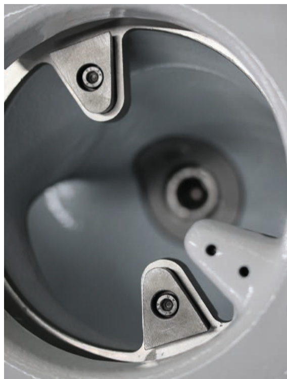
Uitwisselbare hardmetalen snijmesses (HRC 55) van het ASC-systeem.
