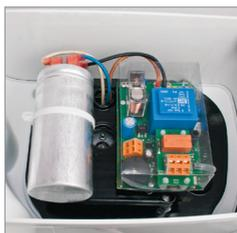
Die im Trockenbereich des Behälters untergebrachte Elektronik steuert und überwacht die Anlage. Im Servicefall kann die komplette Motoreinheit entnommen werden.
