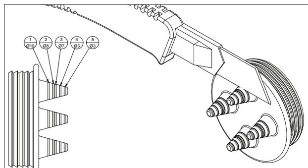
Schneiden Sie entsprechend die Nippel so ab, dass Sie das Pumpenanschlusskabel bzw. den Pneumatikschlauch stramm durch die entstandene Öffnung ziehen können. Bei den Pumpen mit Schukostecker müssen Sie zusätzlich die Kabeldurchführung einmal längs bis zum geöffneten Nippel aufschneiden.
