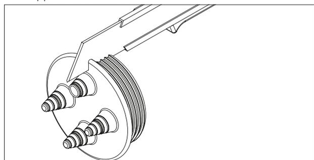
Drücken Sie nun die Kabeldurchführung in die entsprechende Muffe/Abzweigung ihres Entlüftungsrohres.
